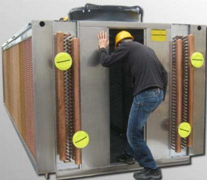
Gegenüberliegend zur Bedienseite ist eine große Wartungstür, die den Eintritt in die Luftkammer zwischen den Wärmetauschern ermöglicht. Eine Inspektion der Lamellen von innen sowie ein Zugang zum Lüftungsmotor sind somit gewährleistet. Jede Ventilatoreinheit kann durch interne Trennbleche abgeteilt werden.
