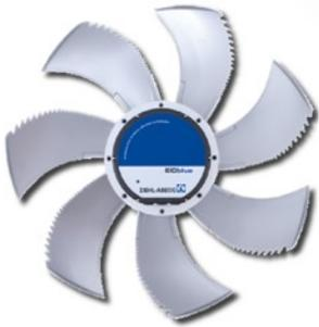
Elektronisch kommutierte Motoren (EC Motoren) sind die neueste Entwicklung, um Energie zu sparen und eine optimale Geschwindigkeitskontrolle zu erreichen. Im Vergleich zu konventionellen AC Motoren gelingt es, den Leistungsverlust um ca. ein Drittel zu minimieren. Das hocheffiziente Flügelblatt erzeugt bis zu 3 db weniger als konventionelle Lüfterflügel mit geringstem Energieverbrauch. Die Garantiezeit dieses Lüfters beträgt drei Jahre.
